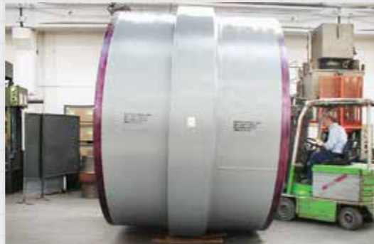
Изолирующая монолитная муфта диаметром 128 дюймов (3251 мм) для водовода
