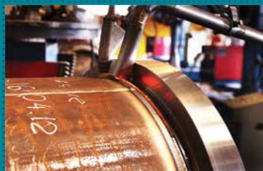
Автоматическая сварка под флюсом
