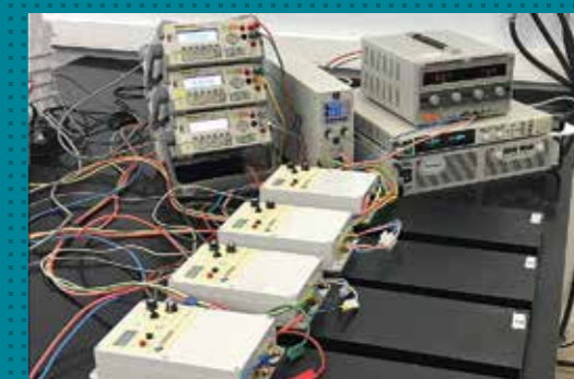
Электрические испытания электронных БСЗ
