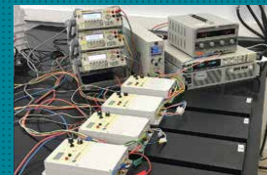
Электрические испытания электронных БСЗ
